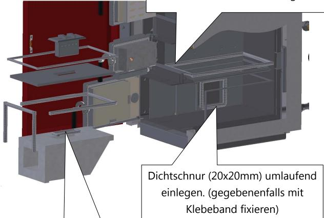
Dichtschur (14x14mm) umlaufend in Brennkammer einlegen.
